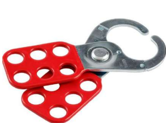
Ejemplo mandíbulas de seguridad múltiples. Varias personas pueden bloquear el dispositivo simultáneamente.
